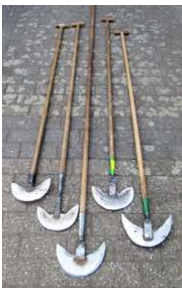
Zelfgemaakt gereedschap om de berenklauw veilig uit de grond te steken.
